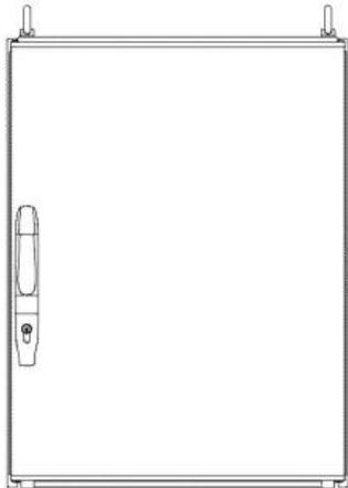
Baie 15U, 19", châssis fixe de 610 x 965 x 630 mm, IP-22
