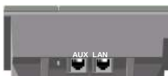
Portas RJ45 na Estação Mestre de Mesa
